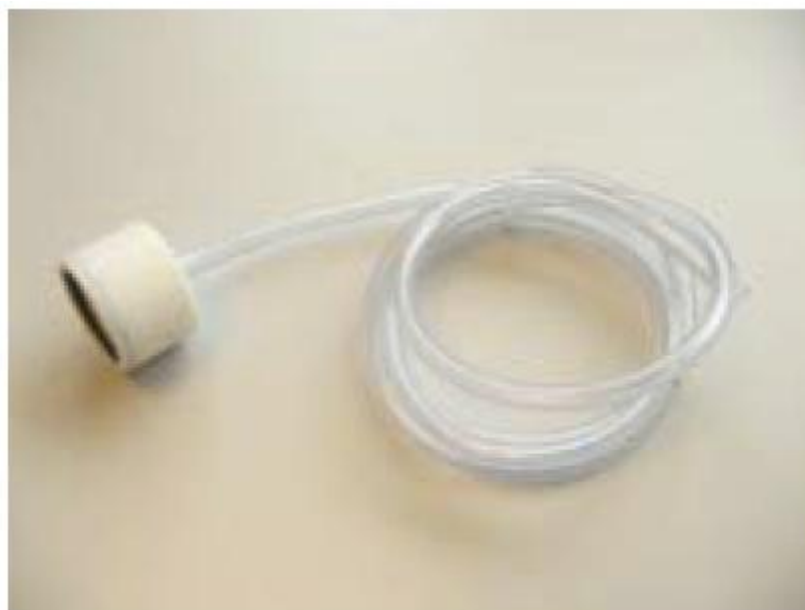
Рис. 6 Калибровочный адаптер Тип: Calibr-set-AT 1110C01
