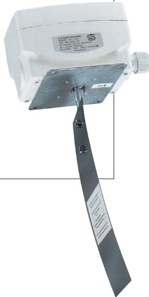
Mechanischer Windfahnschalter **RHEASREG® WFS** mit schaltendem Ausgang, im schlagfesten Kunststoffgehäuse, mit Edelstahl-Paddel, zur Strömungsüberwachung von gasförmigen, nicht aggressiven Medien. Der Strömungsfühler findet Anwendung als Durchflusswächter oder Luftströmungswächter in Luft- und Klimakanälen, in Zu- oder Abluftgeräten von Ventilatoren oder elektrischen Heizregistern (auch bei verschmutzter, ölhaltiger Luft).
