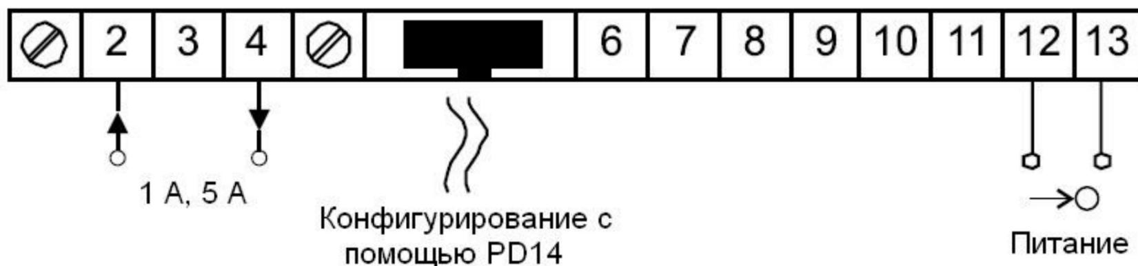
Рис. 7. Схема электрических соединений для приборов N24Z, N25Z и N24H, N25H для измерения тока
