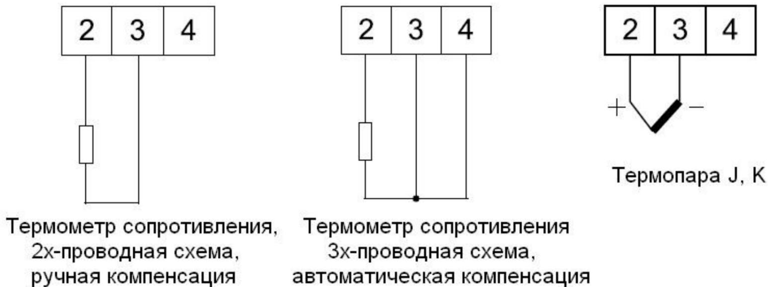
Рис. 5. Схема измерительных входов для приборов N24T и N25T
