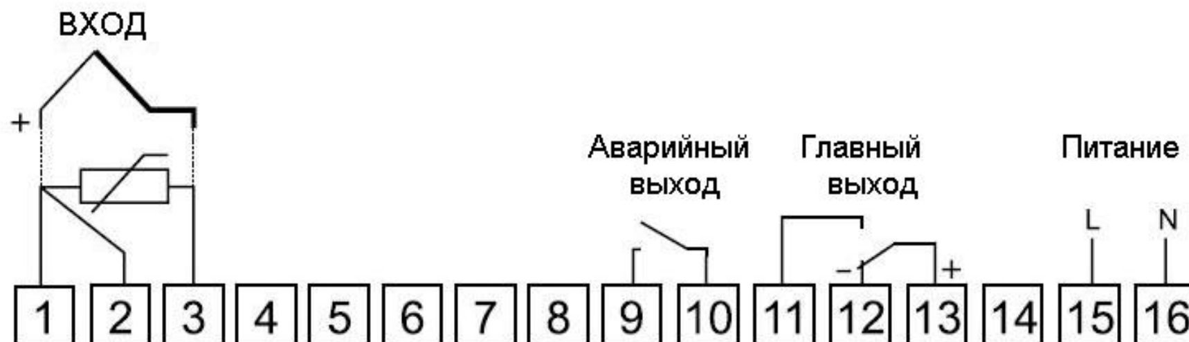
Рис.3. Описание зажимов клеммного ряда регулятора RE55
