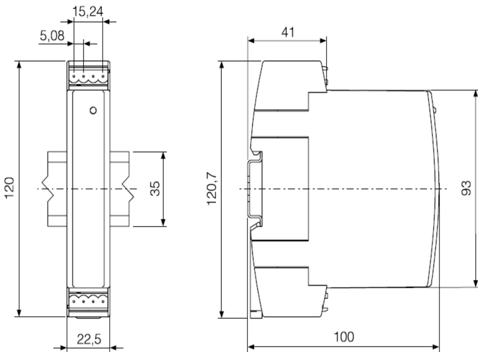
Рис. 1. Габариты и способ монтажа прибора
