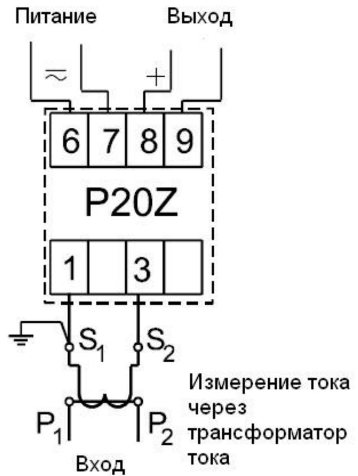
Рис. 2. Электрическая схема подключения преобразователя P20Z
