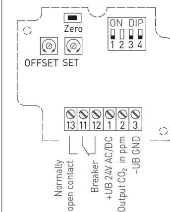
Схема соединения **ACO2-W**
