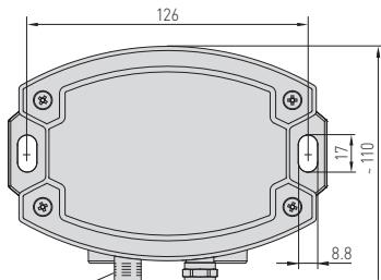
Gehäuse mit M12-Steckverbinder
