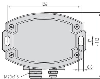
Gehäuse mit Kabelverschraubung
