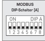
Die **Geräteadresse** im Bereich von **1 bis 247** (Binärformat) wird über den DIP-Schalter [A] eingestellt. Schalterstellung Pos. 1 bis 8 – siehe Tabelle auf Rückseite!
