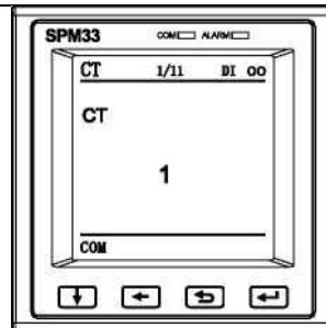
2. Канал связи RS-485: нажмите кнопку
