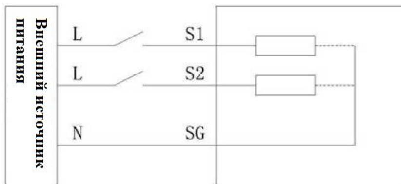
Обычно внешний модуль и соответствующий ЖК-дисплей отображения состояния SPM33 не активны, информация о внутреннем состоянии установлена на 1; внешний модуль отключен, соответствующий ЖК-дисплей отображения состояния SPM33 отключен, информация о внутреннем состоянии установлена на 0.
