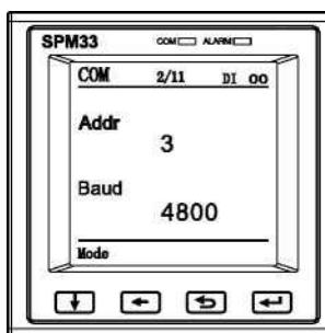
3. Режим соединения: нажмите кнопку
