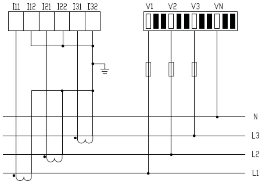
Трехфазная трехпроводная система, 3 ТТ:
