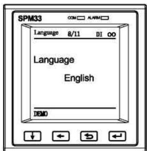
9. Демонстрация: нажмите кнопку
