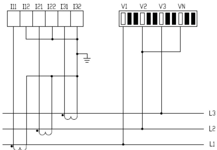
Трехфазная трехпроводная система, 2 ТТ:
