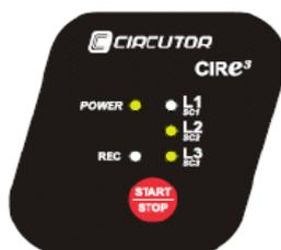
Светодиод L1/sc1 мигает, указывая на неправильность подключения зажима. В этом случае, проверьте зажим, чтобы удостовериться, что он плотно сомкнут и подключен в соответствии с направлением тока электроустановки, указанным стрелкой, и связан с соответствующей фазой L1, L2 или L3 с учетом цветовой маркировки напряжений, в качестве которой используются ЧЕРНЫЙ, КРАСНЫЙ и ЖЕЛТЫЙ цвета, соответственно.
