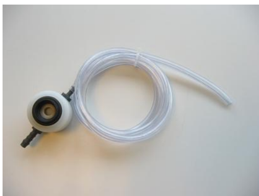
Рис. 5. Калибровочный набор AT 3300S01
