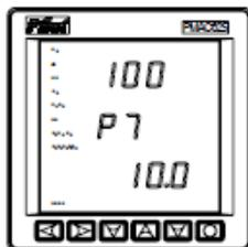
Значение ТТ (трансформатор тока): Значения внешнего первичного ТТ и вторичного ТТ. На первой строке отображается фиксированное значение вторичного ТТ (не программируемое). На третьей строке отображается программируемое значение первичного ТТ (диапазон: 1~9999).
