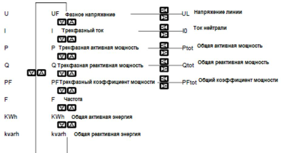
Примечание: Некоторые параметры поддерживаются только определенными моделями. В моделях РМАС625-Z или РМАС625Н на дисплее отображаются все электрические параметры.
